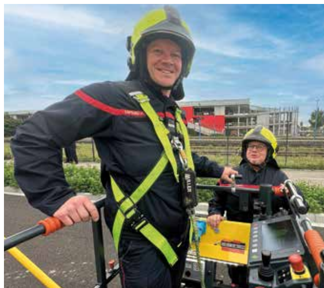
L'adjudant chef Raphaël Martin a suivi une formation d'échelier durant cinq jours pour pouvoir piloter l'EPC qui dispose de deux postes de commandement, le premier dans la tourelle et le second sur la plate-forme.
