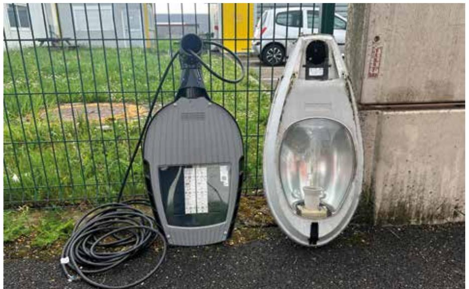
*Les lampes à technologie Led (à g.) remplacent petit à petit les ampoules au sodium haute pression.*
