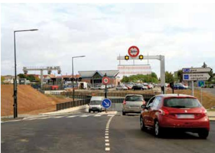
Des portiques de limitation de hauteur ont été installés en amont et en aval du tunnel pour empêcher les véhicules d'un gabarit de plus de 3,65 m de s'aventurer dans le passage souterrain.
