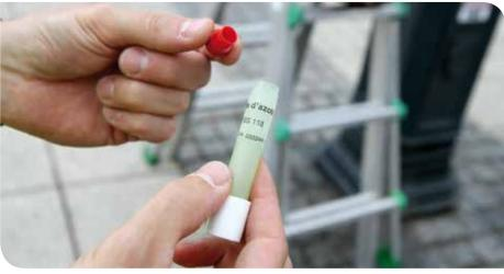
Les molécules de dioxyde d'azote ou NO, sont piégées sur un adsorbant
