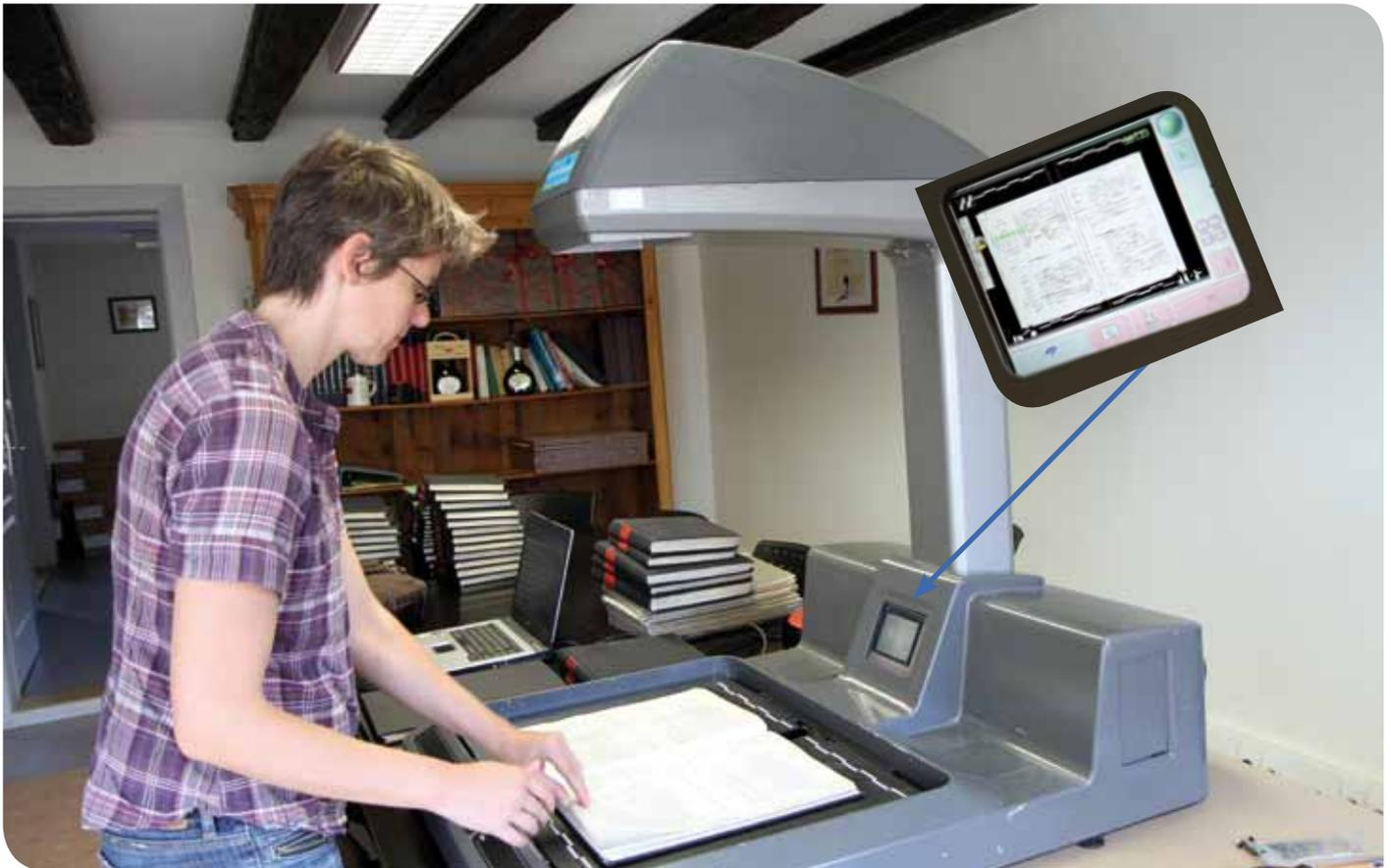
*Un système de rainure permet de poser le registre d'état civil à plat sans l'abîmer. Après chaque numérisation de page, l'opératrice vérifie sur le petit écran intégré que le fichier est exploitable.*
