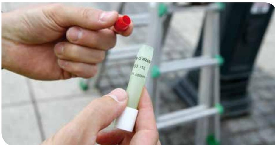
*Les molécules de dioxyde d'azote ou NO<sub>2</sub> sont piégées sur un adsorbant*
