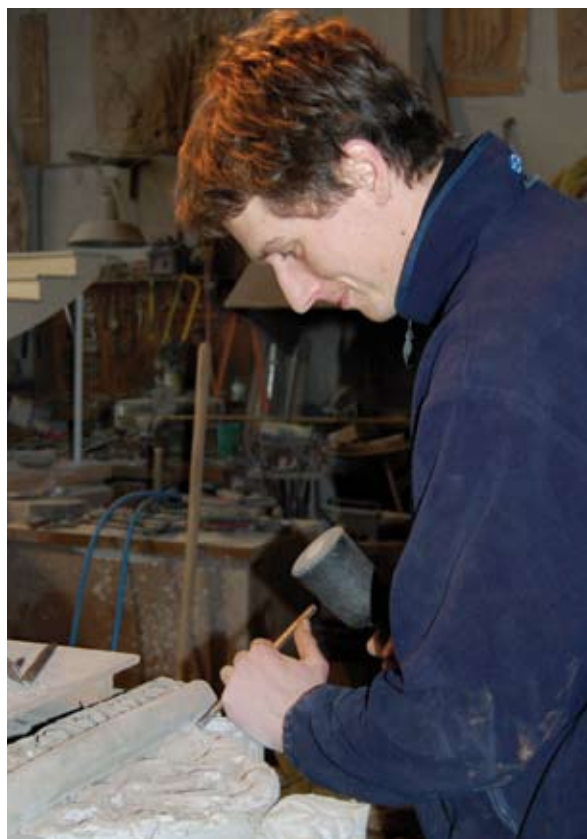
Nicolas, l'un des deux chefs d'équipe, travaille sur la restauration d'un monument funéraire. Pour y parvenir, il dispose de tout un arsenal de ciseaux,
